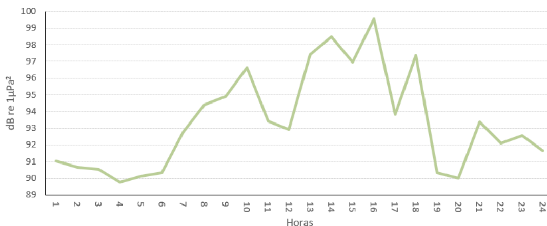
Ilustración 26. Nivel presión sonora medio (RMS medio ) de 24 horas del punto H1.
