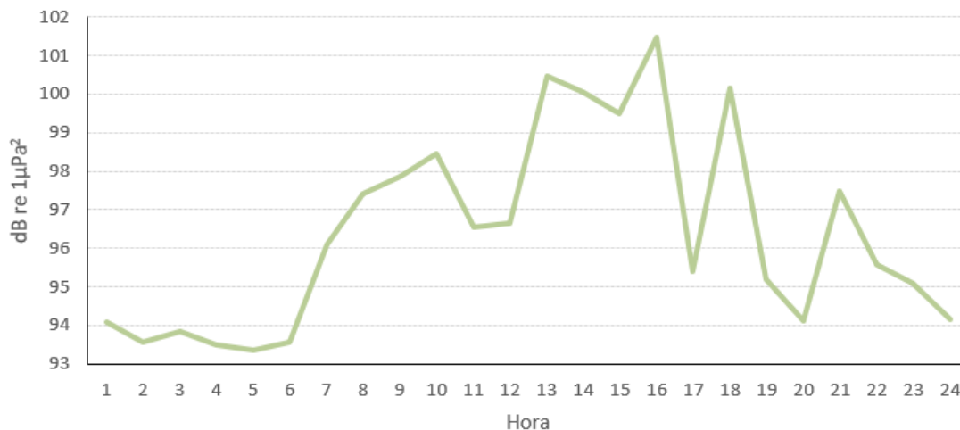
Ilustración 29. Nivel presión sonora medio ( RMS_{medio} ) de 24 horas del punto H2.
